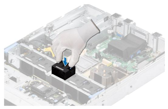
Figure 29. Installing a cooling fan
