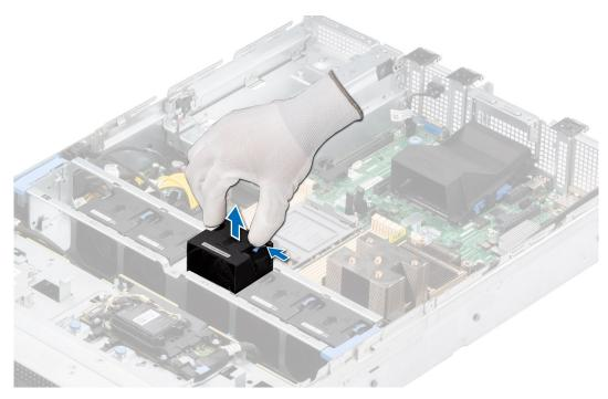
Figure 28. Removing a cooling fan
